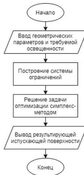
Рис. 1. Блок-схема основного алгоритма
