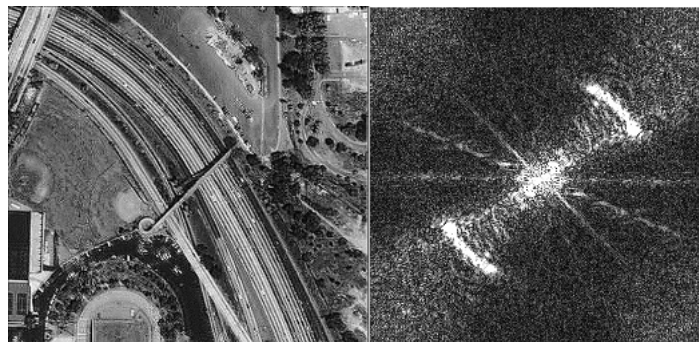
Рис. 3. Ikonos_sandiego_usa_1m и его ПЧС при использовании метода возмущений и миграции поля для коррекции операции улучшения резкости с выполнением необходимой дообработки оператором деконволюции
