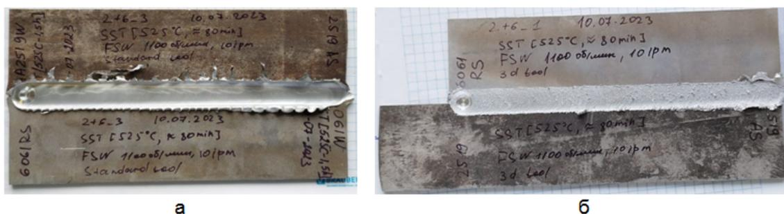
Рис. 2. Внешний вид полученных сварных соединений: а – стандартным инструментом, б – аддитивным
