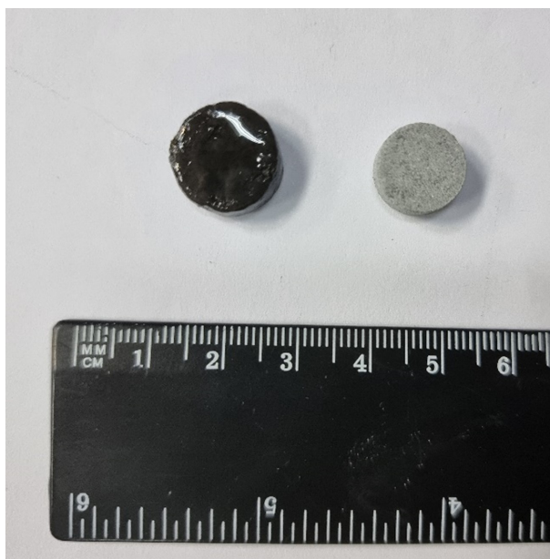
Рис. 1. Распределение кристаллов сульфата кальция в объеме эпоксидной смолы
